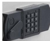
Serrure électronique norme Européenne ENV 1300 classe 2 VDS. 1 000 000 de combinaisons, 1 code maître et 1 code utilisateur programmables. Alimentation par pile 9 volts accessible sous le clavier.
